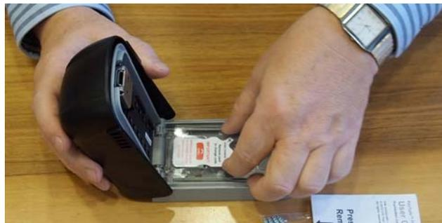
1.5 Bewegen Sie den Gehäusedeckel (grau) wieder so weit zurück (nicht schließen!) und drehen Sie den Drehknopf um 180 Grad gegen den Uhrzeigersinn. Nun kommen an der Rückseite des Gehäusedeckels die Einstellschrauben zum Vorschein.
