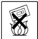
Setzen Sie das Produkt nie größerer Hitze und offenem Feuer aus. Temperaturen über 55°C zerstören das Gerät.
