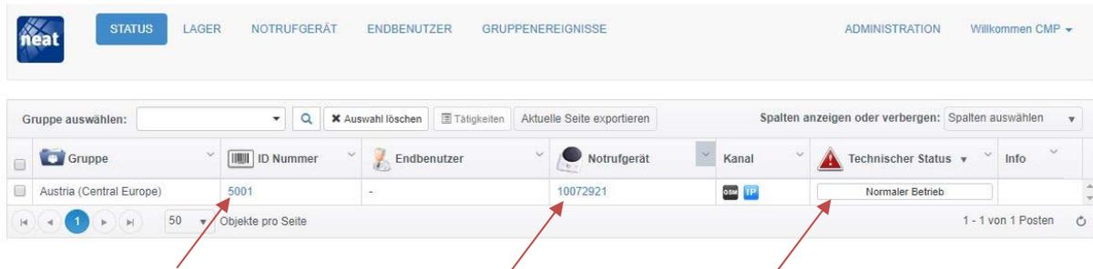
1.2 Klicken Sie bei dem Gerät welches Sie umprogrammieren möchten auf die ID-Nummer, Seriennummer oder den technischen Status. Sie gelangen nun automatisch in die Registerkarte „Notrufgerät“ mit den technischen Details zum ausgewählten Notrufgerät.
