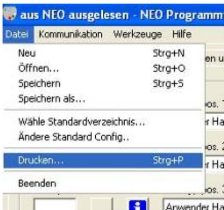
Über dieses Menü können Sie die gerade im NEO Programmer enthaltenen Programmierdaten vollständig ausdrucken.
