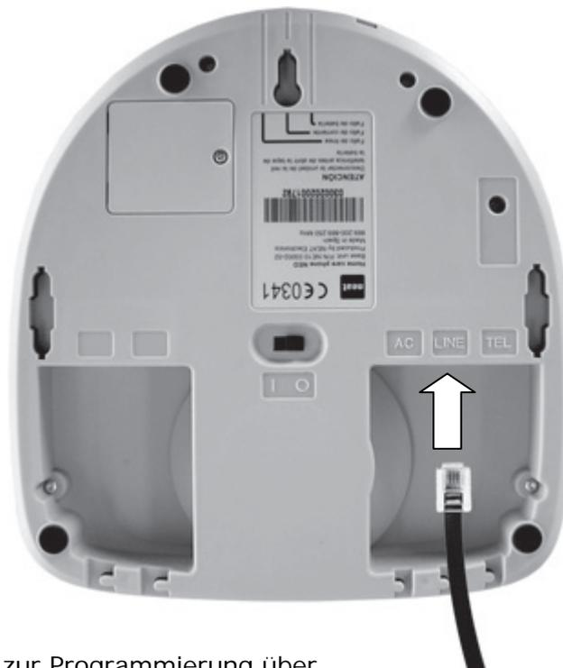
Das Handterminal wird zur Programmierung über die LINE Buchse am NEO angeschlossen.
