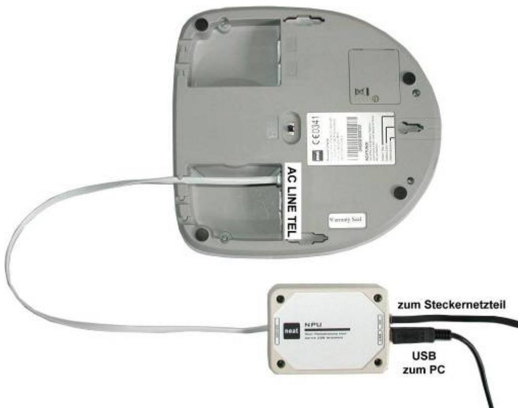
**Kabelanschlüsse von und zur NPU**
