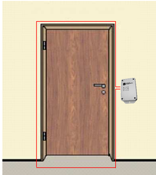
Antennenschleife um die Tür herum
