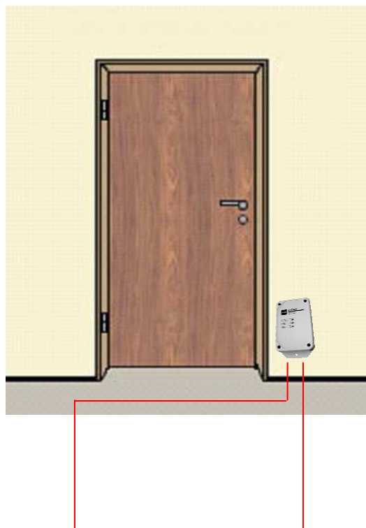
Schleifenantenne im Fußboden
